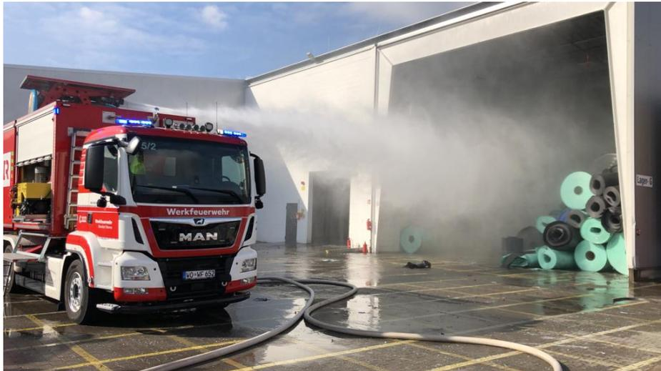
**Entrauchung:** Die THJ-Module lassen sich auch für die Entrauchung und Belüftung von Hallen, Lagern und Tunneln einsetzen.
