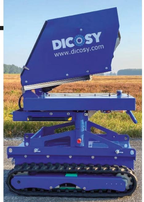
**Kleiner Bruder:** Das Modul THJ 80 lässt sich auf Lafetten oder an den Korb eines Hubrettungsfahrzeugs montieren.
