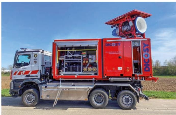
**Schweiz:** Das THJ-Modul 4000 der Werkfeuerwehr der Lonza AG ist auf einem kurzen Abrollbehälter für ein WLF mit kurzem Radstand montiert.
