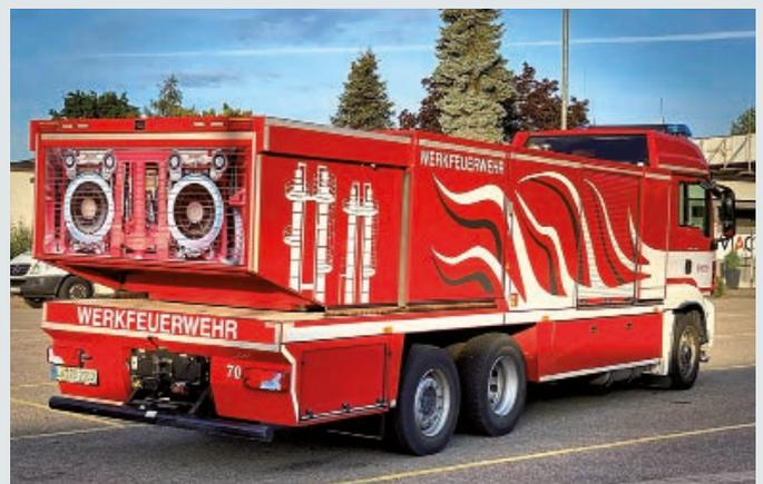
**Umbau:** Der Turbolöscher mit der Baunummer 7 wurde modernisiert und dabei von Kerosin auf Diesel umgerüstet.
